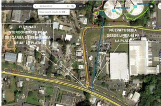
Se recomienda la instalación de una interconexión entre la tubería existente de 48" ubicada en la PR-2 (proveniente de la Planta de Filtros La Plata) y la entrada de la Estación de Bombas Toa Baja en el TWST del Superacueductos en Bayamón.
