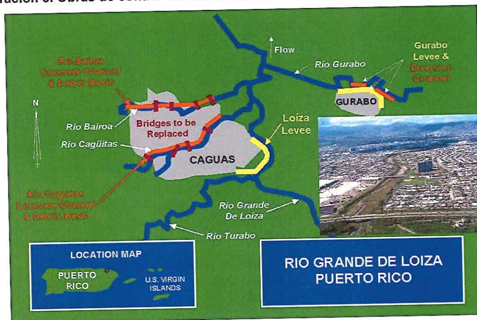
Ilustración 5. Obras de control de inundaciones en los ríos Grande de Loíza y Gurabo
