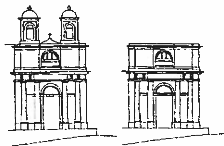
Ej. La remoción de las torres-campanario de la fachada de la iglesia del convento de las Carmelitas, afectó el carácter del edificio, alterando su altura original y desvirtuando la composición de la fachada
