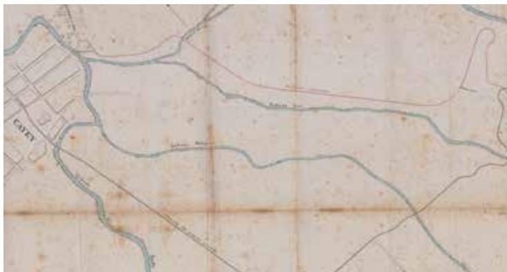
Figura 3. Vista parcial del plano de 1887 de Schar que muestra el replanteo del punto de inicio de la ruta y los cuerpos de agua en las cercanías de la ruta propuesta (en rojo).
