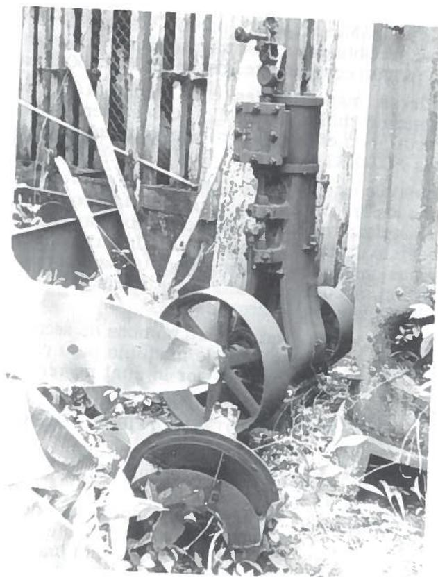
FOTO 33 Máquina de vapor vertical. A la derecha se ve parte de la caldera con la hornalla; al frente, el aspa impulsora de un abanico centrifugo. Este sistema de vapor movía una despulpadora y un bombo, y su vapor exhausto calentaba el aire para el secado. Hacienda Córcega (Pericci), San Germán. U.P.R., 1978.
