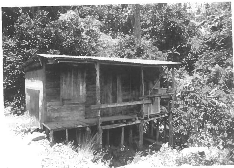
FOTO 14 Casa de una hacienda pequeña. En sus bajos hay una despulpadora de rollo pequeña y un tanque de fermentación. El café medido se echaba directamente en la chorrera de la máquina. Barrio Indiera Baja, Maricao, 1988.
