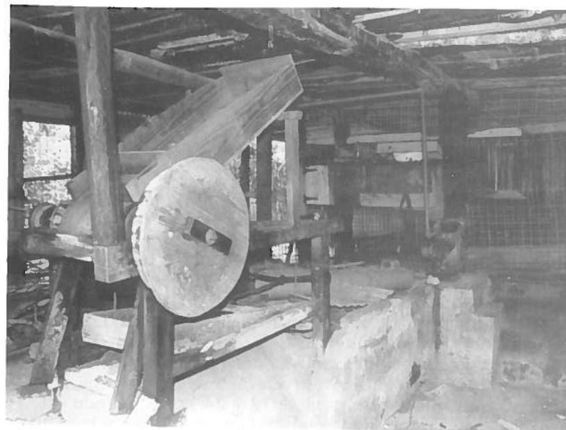
FOTO 26 Despulpadora de rollo. Ubicada junto a un tanque de fermentación de mampostería en los bajos de la casa de una hacienda mediana. Bajo la zaranda de la máquina hay una chorrera que dirige el café despulpado hacia el fondo del tanque. A la máquina le falta la chorrera por donde caía la cáscara de la uva. Hacienda Cojoba Isleta, San Germán, 1988.
