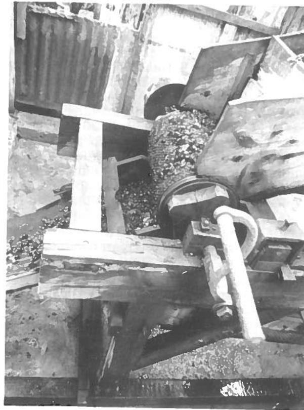
FOTO 5 *Despulpadora de rollo manual en uso. El cilindro de madera tachonada o rollo retiene la cáscara de la uva adherida y la deja caer por una chorrera hacia afuera, mientras que los granos despulpados, de color blancuzco, caen hacia un tanque. El marco de esta máquina está construido en madera con tarugos, pero las piezas mecánicas son de metal. Bo. Duey Alto, San Germán, 1988.*
