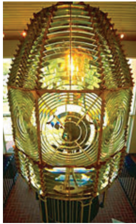
De izquierda a derecha: Ejemplo de lente Fresnel Faro actual de El Morro , Viejo San Juan
