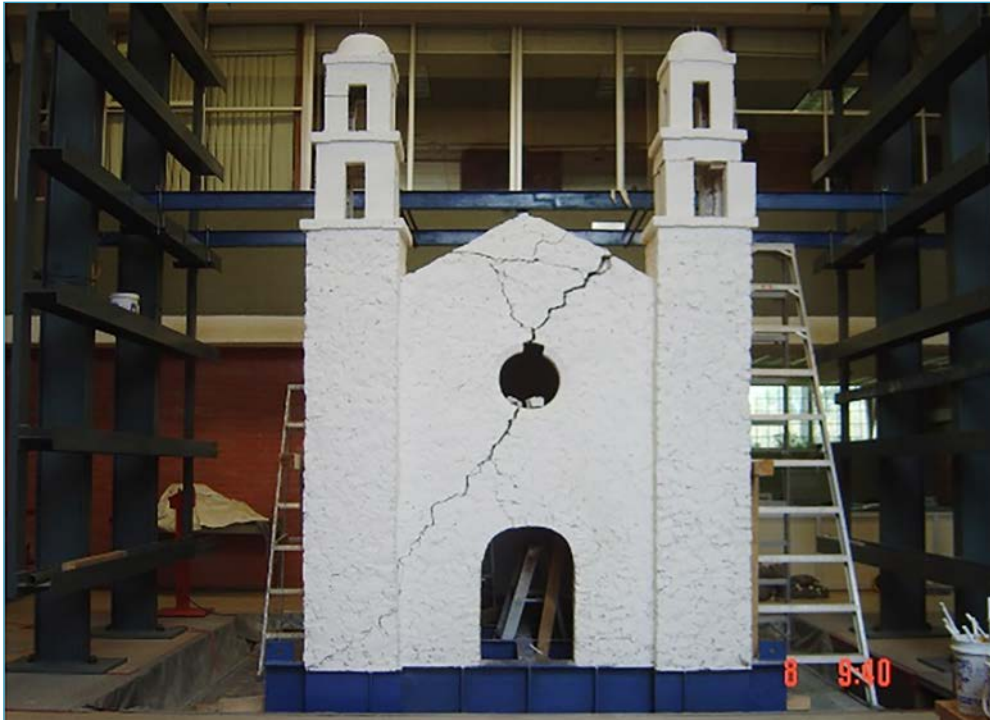
Modelo a escala 1:8 de un templo característico del estado de Puebla ensayado en la mesa vibradora del Instituto de Ingeniería de la UNAM. (Foto e imagen: Marcos M. Chávez Cano)
