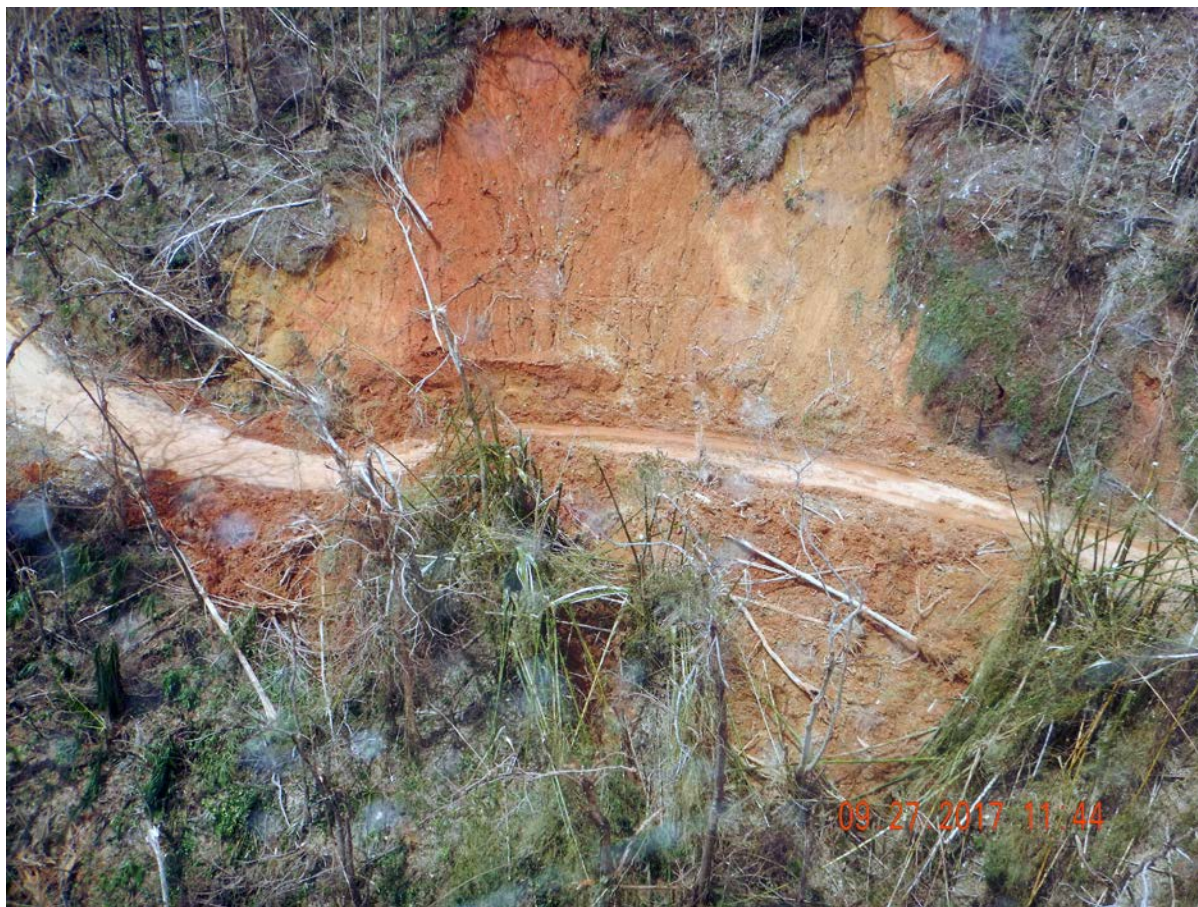
Vista aérea de un derrumbe de terreno en la carretera PR-191 durante la inspección en helicóptero. (Fuente: Raymond Feliciano, Servicio Forestal)
