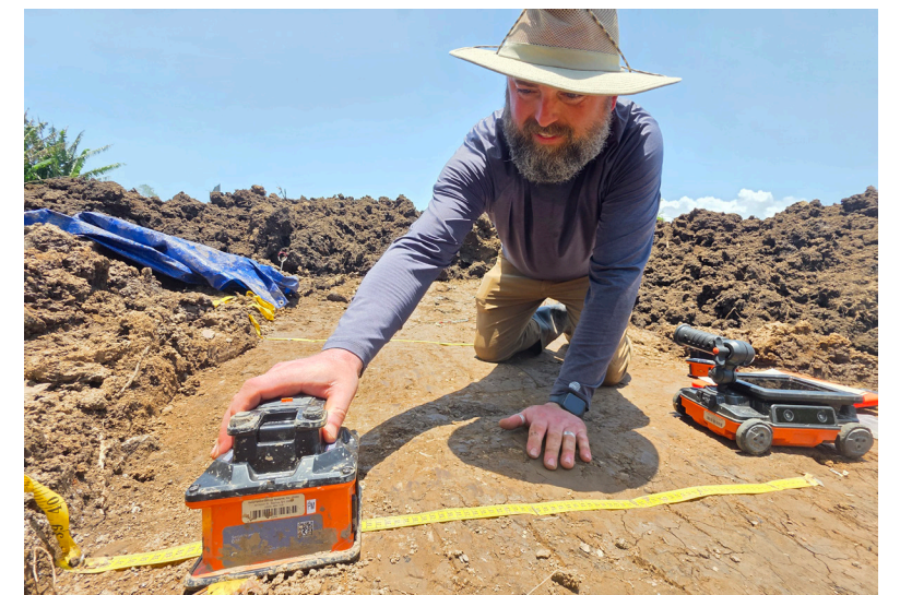
Especialista en GPR utilizando el FLEX NX conectado al NX25. Fuente: Joost Morsink.
