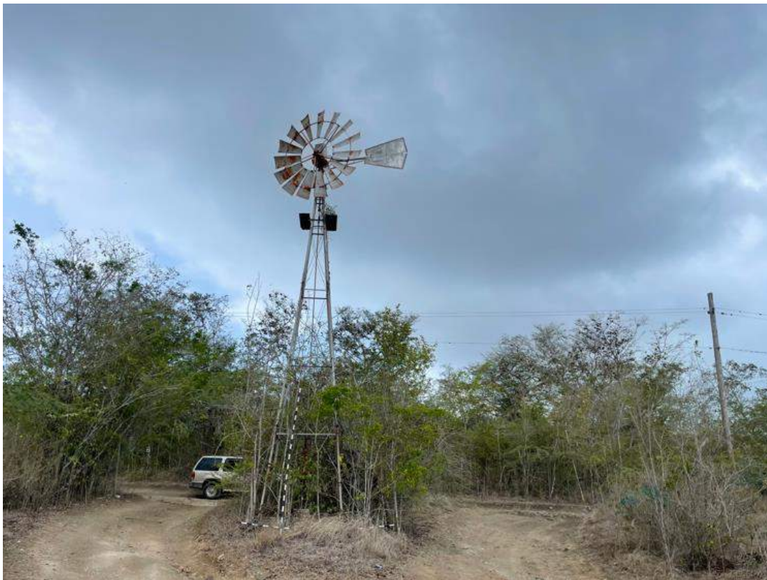
Foto 6. Elemento H-3, molino de viento para extracción agua.
