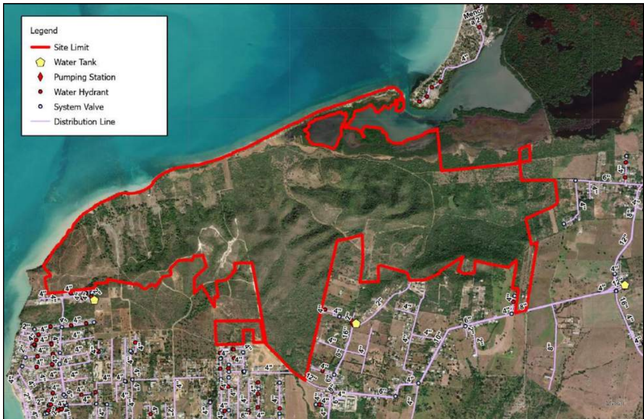
Foto 1: Líneas de Agua de AAA
