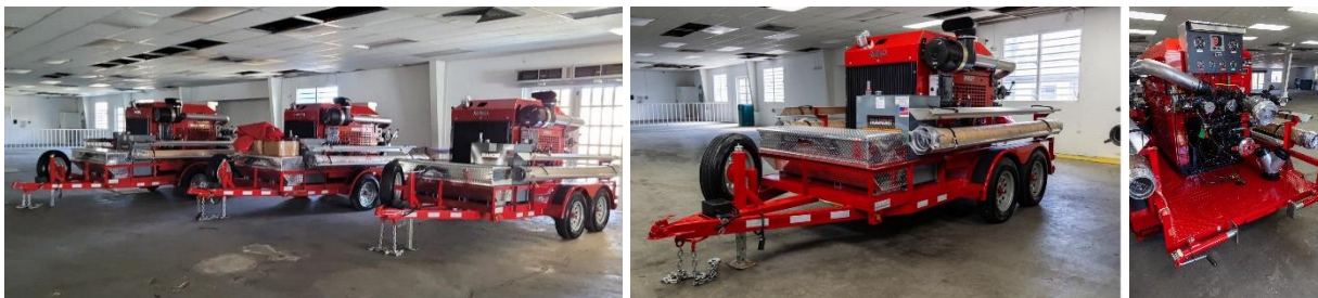
Fotos de las tres bombas de supresión de incendios recibidas para zona portuaria de Puerto Nuevo.
